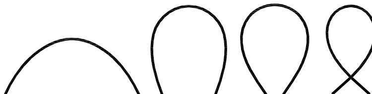
Obrázek 1: Vznik smyčky při pokritickém vzpěru přímého prutu
